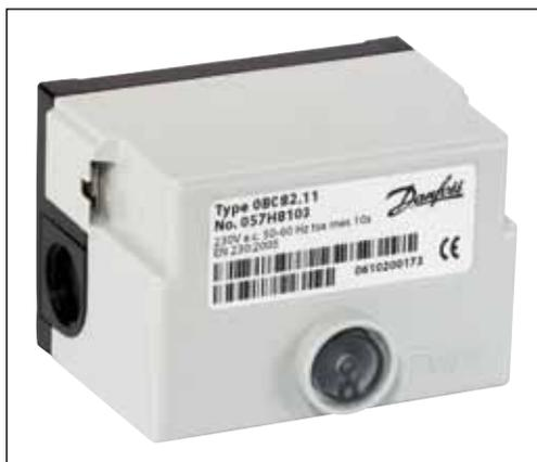
Der mikroprozessorgesteuerte Ölfeuerungsautomat OBC 82.11 hat, unabhängig von der Versorgungsspannung und der Umgebungstemperatur, präzise und stabile Programmzeiten. Der Automat ist unterspannungssicher gemäß EN 230:2005.
