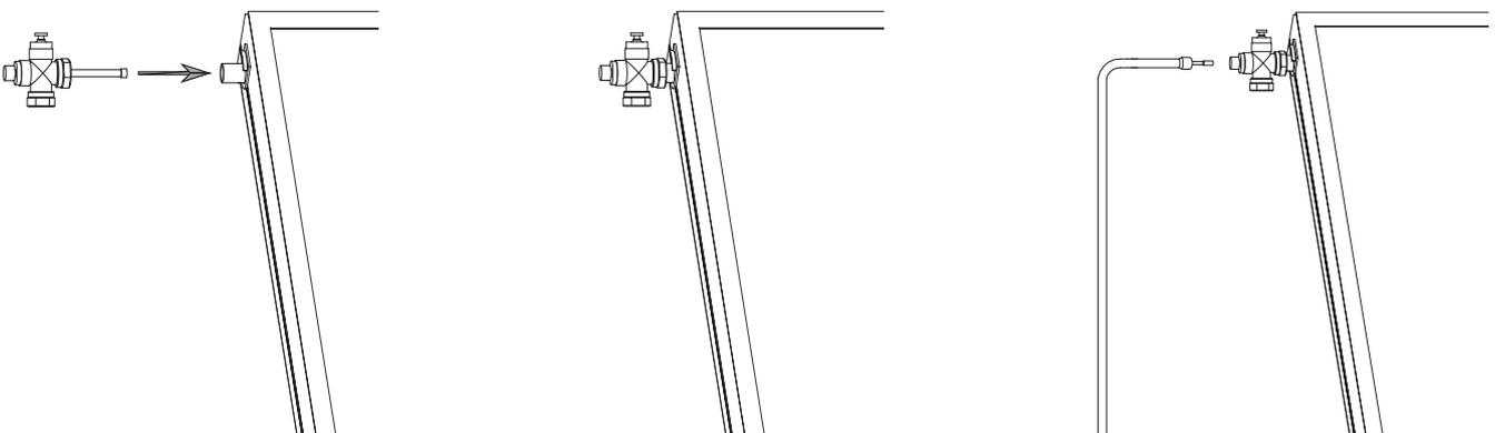
**!** ACHTUNG: Die Kreuzverbindung mit einer Eintauchbuchse und der manuellen Entlüftung sollte an der Einspeisung Seite montiert werden, und den Kniestück an den Rücklauf anbringen.
