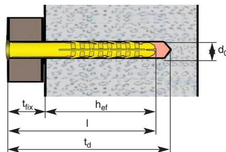
t<sub>fix</sub> : Epaisseur maxi à fixer en mm
