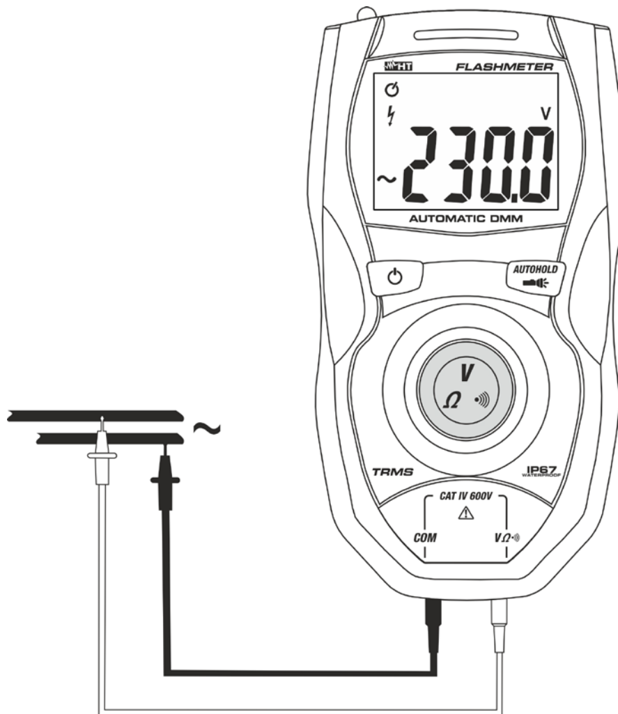
Abb. 4: Verwendung des Gerätes für Wechselspannungsmessung
