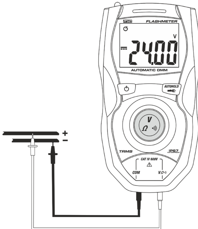
Abb. 3: Verwendung des Gerätes für Gleichspannungsmessung
