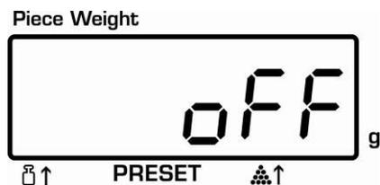
**Check off** – Toleranzkontrolle ausgeschaltet
