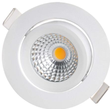
Dimmbarer Einbaustrahler mit integrierter LED-Lampe. Dieses Downlight arbeitet nach dem Prinzip dimm-to-warm. Das bedeutet, dass die Lampe eine wärmere Farbe erhält, je mehr sie gedimmt wird. Die Farbtemperatur variiert von 2000-2700K. Dieser Strahler hat einen CRI-Wert von <95, mit dem die Farben hervorragend dargestellt werden. Aufgrund der Schutzart IP44 ist dieser Strahler für Bad, Toilette oder Küche geeignet.
