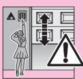
Festinstallierte Steuerungsgeräte (wie Taster etc.), sind in der Sichtweite des Tores zu montieren, aber entfernt von sich bewegenden Teilen und in einer Höhe von mindestens 1,5 m. Sie sind unbedingt außer Reichweite von Kindern anzubringen!
